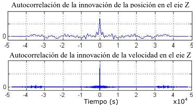
Figura 11.12: Auto-correlaciones de las innovaciones de las medidas GPS de posición y velocidad según el eje Z (ECEF).
